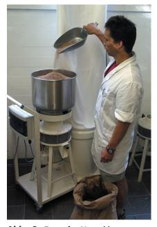
**Abb. 2:** Zentrofan-Vermahlungssystem [Quelle: BFEL, Detmold]
